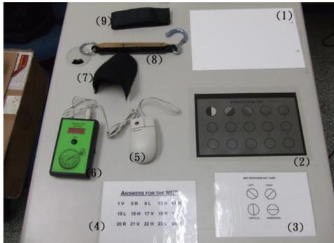
圖 3-1 生理概廓評估工具 a-白色壓克力板(1)、測試透明表(2)、對照卡(3)、答案卡(4)、滑鼠(5)、定時器(6)、泡棉墊(7)、彈簧計(8)、連結帶(9)
